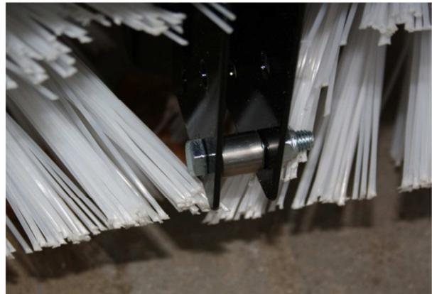
3. Schieben Sie die großen Unterlegscheiben auf die Aufnahmestangen, bevor Sie auf diese das Räumschild stecken. Achten Sie darauf, dass der Haken am Räumschild an der anfangs montierten Hülse einhakt.
