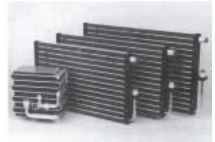
Bild 4: Aluminiumkühler, unter Schutzgas gelötet und lackiert; im Vordergrund ein Aluminiumverdampfer (gelötet und chromatiert)
